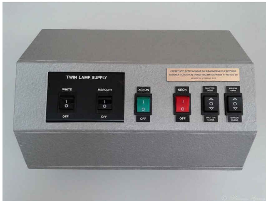
Εικόνα 8: Μονάδα ελέγχου φασματογράφου στο Γεροσταθούλειο Πανεπιστημιακό Αστεροσκοπείο Αθηνών. Πηγή: Kosmas Gazeas' Website, Φασματοσκοπία, http://users.uoa.gr/~kgaze/research_spectroscopy_gr.html
